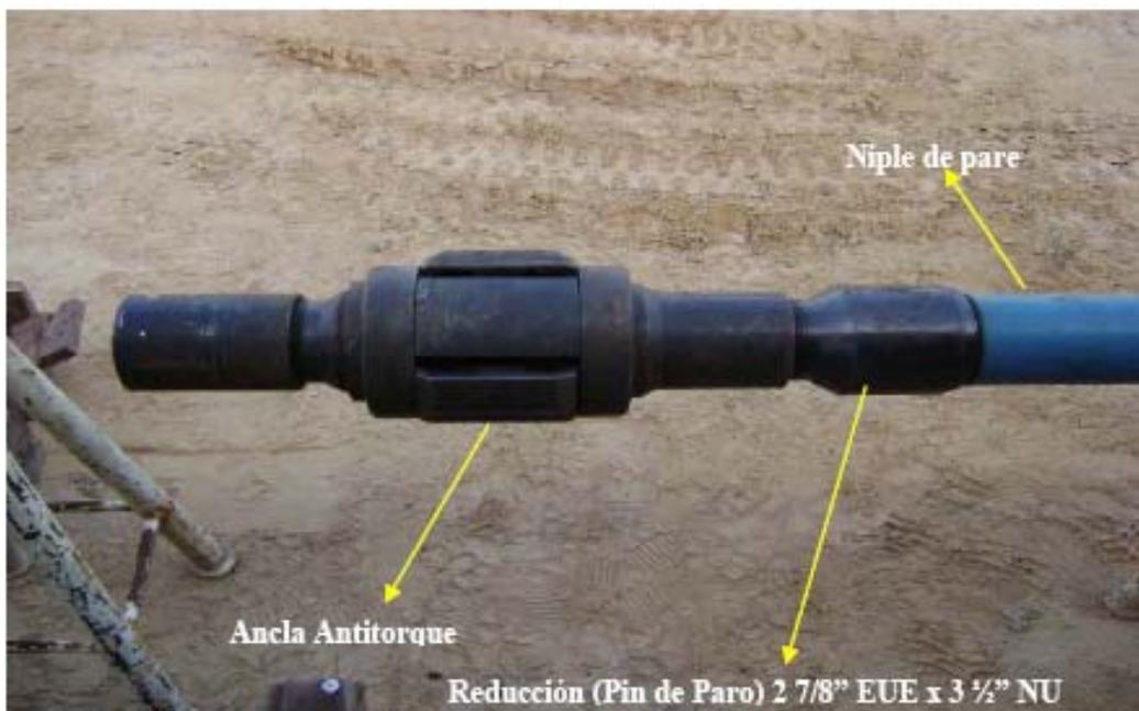
**Ancla de torque instalada en el extremo de la bomba**
