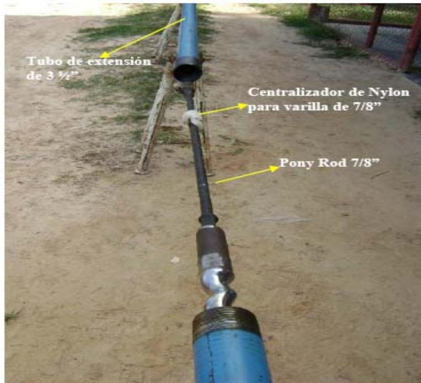
**Vista del rotor con el pony rod y el centralizador de varilla respectivo**
