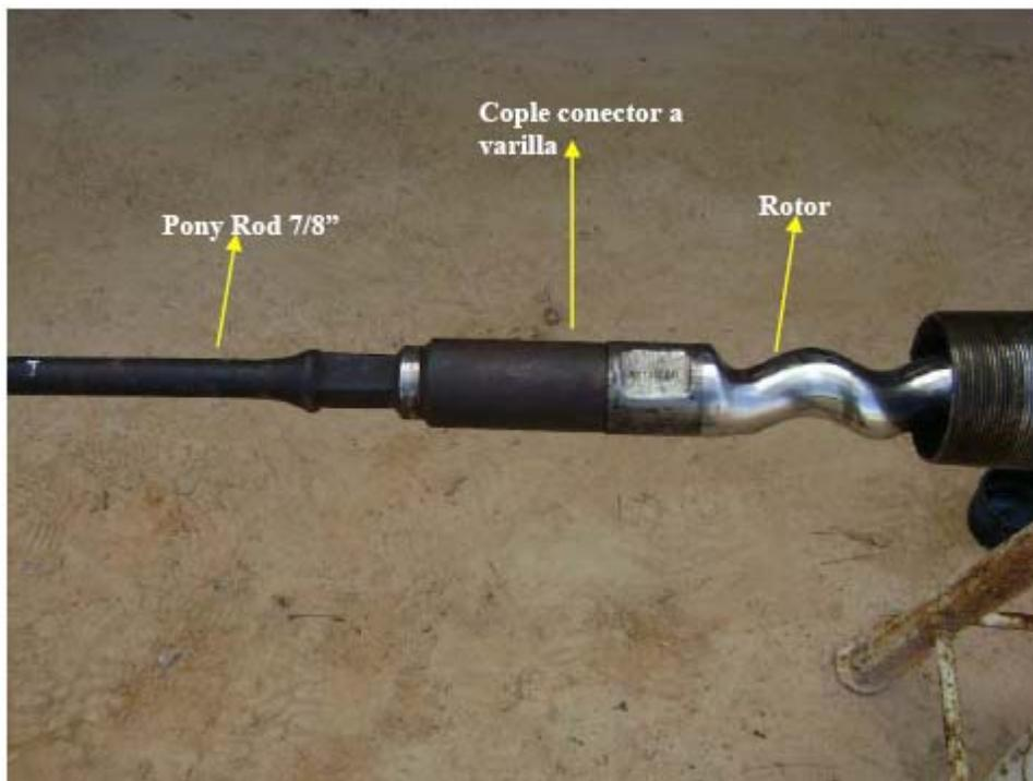
**Vista de las conexiones de varillas con el rotor de la bomba**
