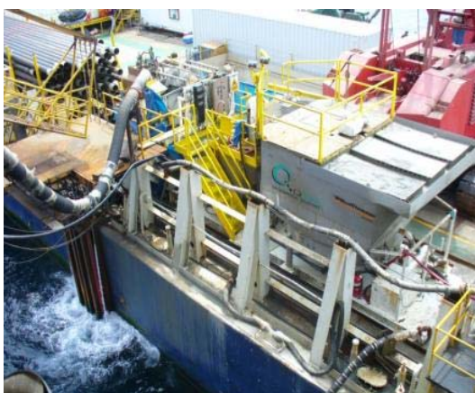
Fig. 4.4- Tecnología de separación de sólidos (stripping out) MudStripper
