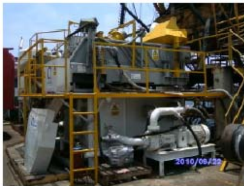
Fig. 4.3- Zaranda con circuito de presión para lavado de recortes
