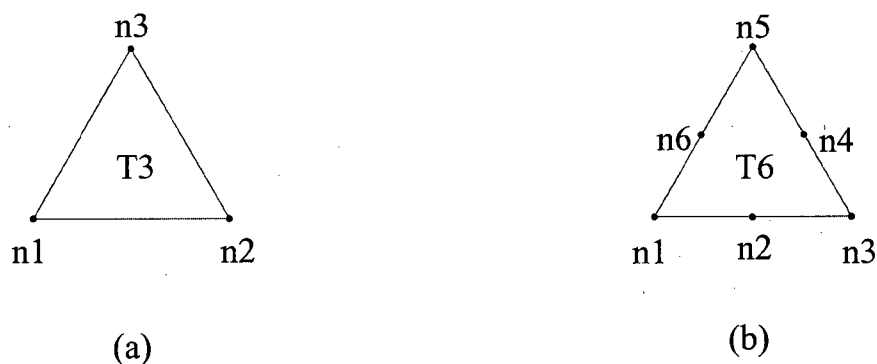
Figura N° 3.9: (a) Elemento finito triangular de 3 nudos (T3). (b) Elemento finito triangular de 6 nudos (T6).
