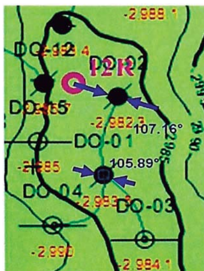
Ilustración 37 - Dirección del Esfuerzo Horizontal Máximo – Dorissa1 y Dorissa2
