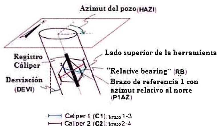
Ilustración 21 - Geometría de la herramienta de cáliper de 4 brazos en el pozo y las variables usadas para interpretar los “breakouts”. 171
