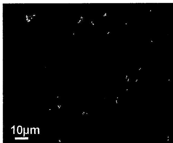
Figura 13. Imagen SEM del soporte de titanio tras el acondicionamiento superficial mediante ataque químico. 1250 aumentos
