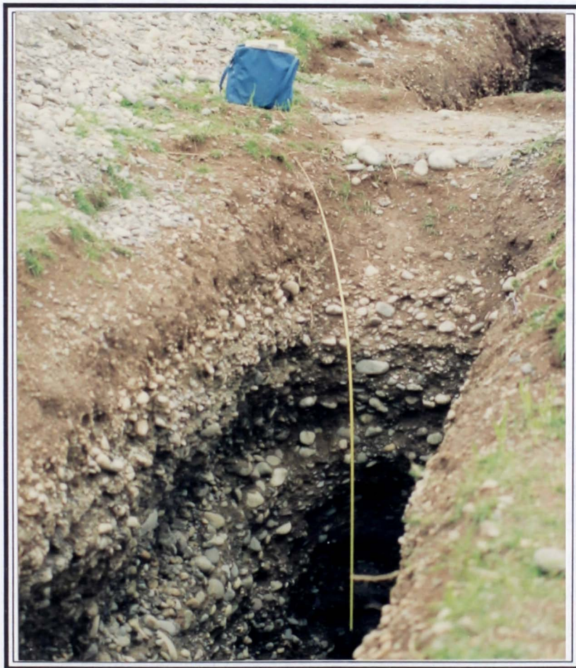
Foto 2: En la vista se observa el perfil de las zanjas realizadas anteriormente (prof.:5,0 m). Notese el material de la zona donde predomina un material de cultivo inicialmente seguido de un material areno-gravoso despues de los 0,40 m. Se encuentra en estado semi-compacto y se estima un q_a >= 1,50 \text{ kgs/cm}^2 .
