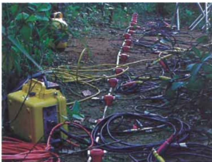
Figura 3.9. Equipo de medición para ensayos de refracción sísmica y MASW
