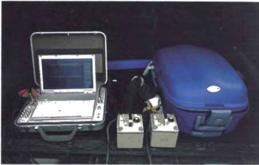
Figura 3.11. Equipo de medición de microtrepidaciones
