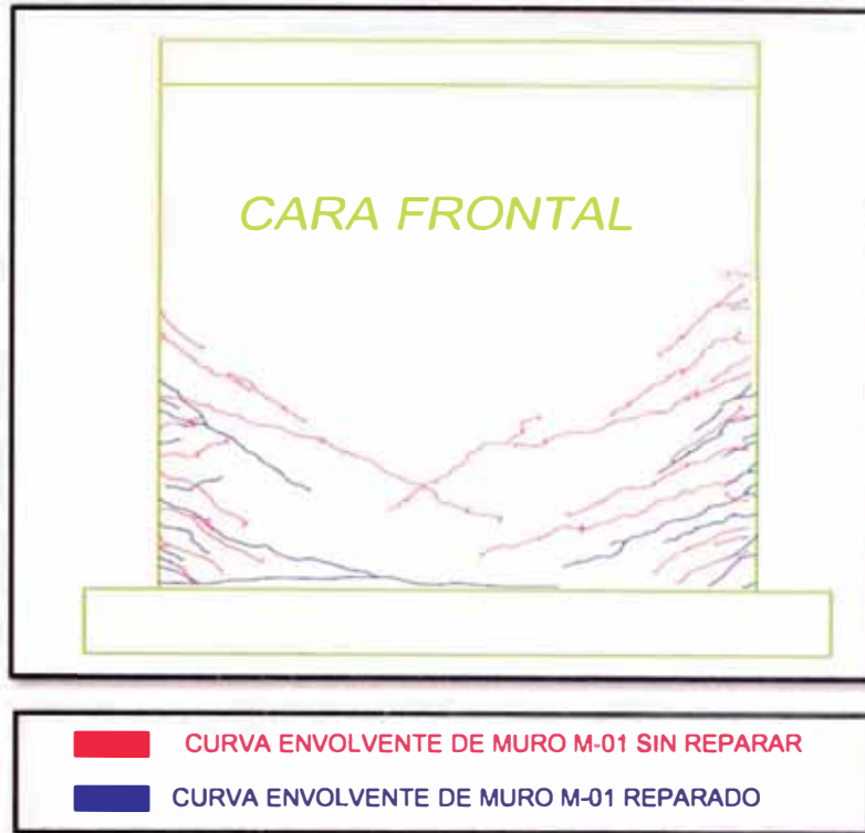
Fig. 4.63 Patrón de grietas de espécimen M-01 reparado y sin reparar– Cara frontal
