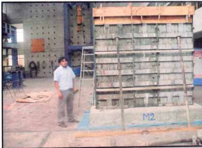
Fig. 3.16 Vista del acople entre el encofrado metálico y el encofrado de madera para un vaciado monolítico muro – viga de transferencia
