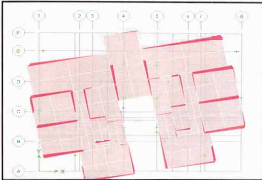
Fig. 5.33 Primera forma de Modo del bloque típico del proyecto Bosques de Ciudad 2000-II
