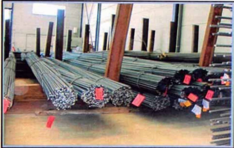
Fig. 2.12 Vista panorámica del almacenaje de las varillas de refuerzo convencional dúctil
