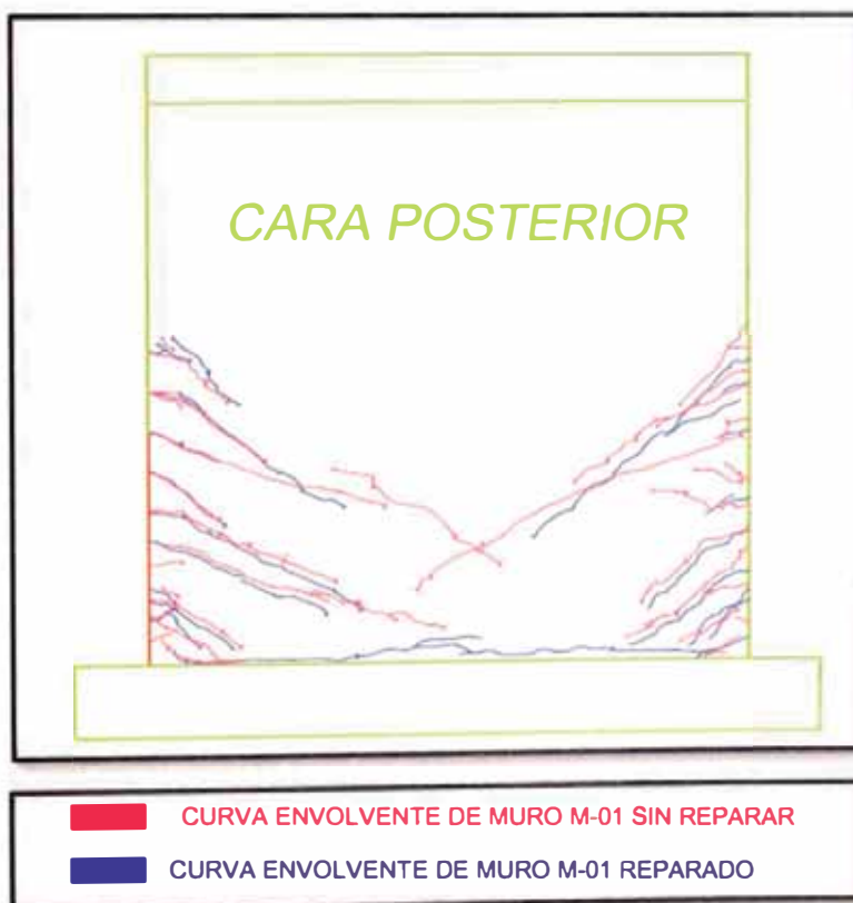
Fig. 4.62 Patrón de grietas de espécimen M-01 reparado y sin reparar – Cara posterior
