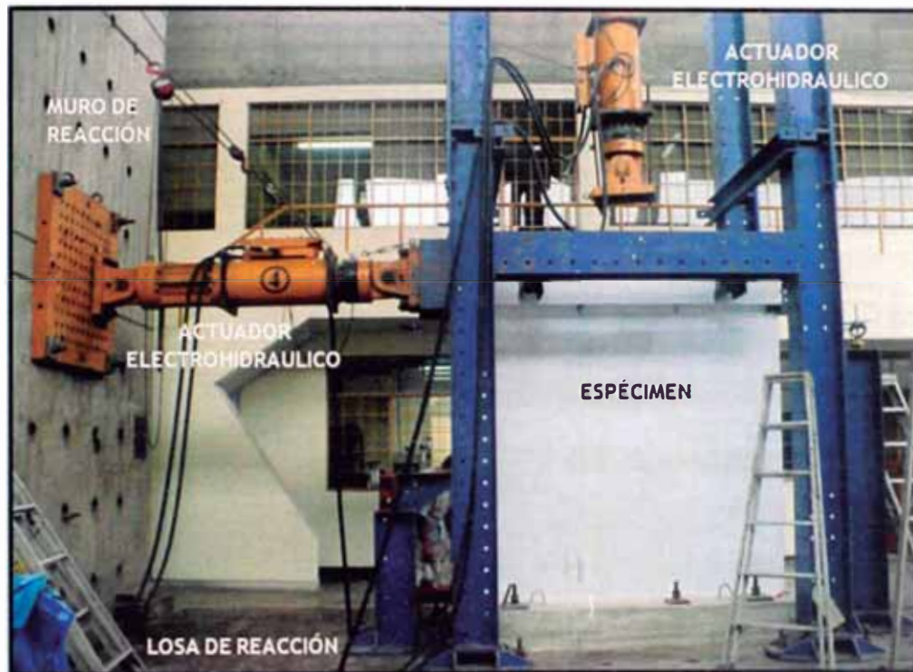
Fig. 3.1 Sistema de instrumentación para ensayo de carga lateral cíclica
