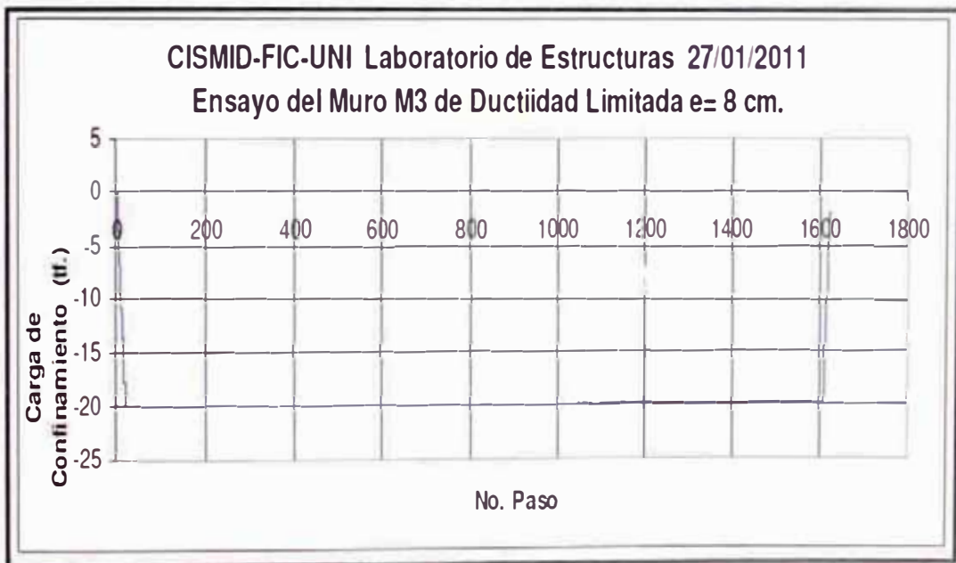
Fig. 4.40 Registro de la carga vertical o de confinamiento vs el N° de pasos.
