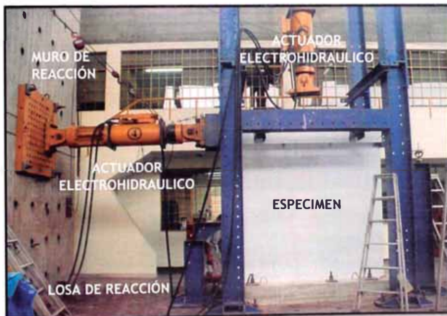
Fig. 4.1 Esquema para el ensayo de carga lateral cíclica
