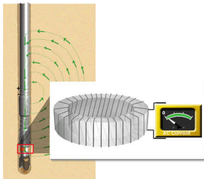
Figura 19. Uso de la broca como electrodo.
