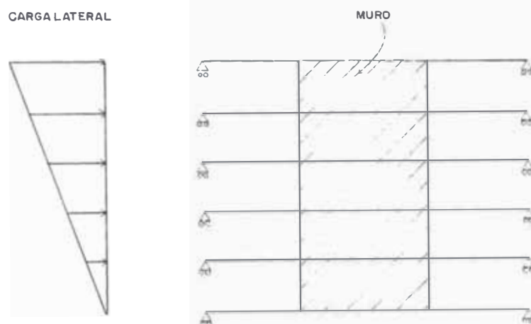
Fig. (2.17): MURO DE PISOS MÚLTIPLES
