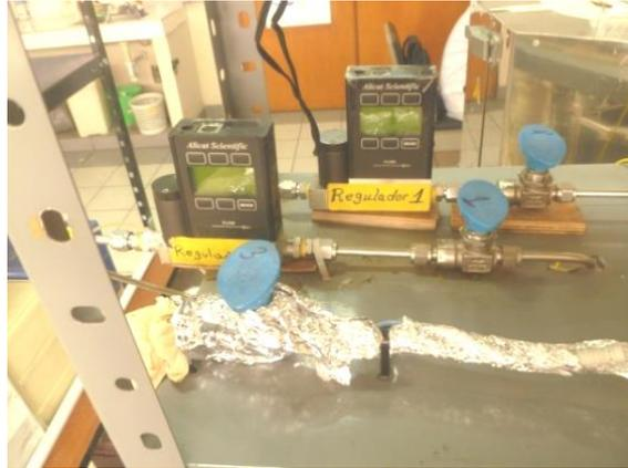
*Figura 4.3 Medidor/controlador de flujo másico de gases.*
