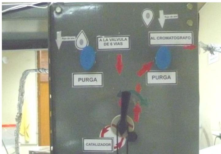
**Figura 4.8** Válvula de cuatro vías.
