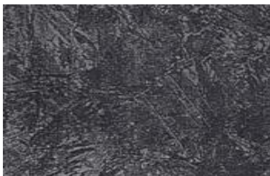
Figura 5. Ferrita y perlita, acero 0.60%C, 200X
