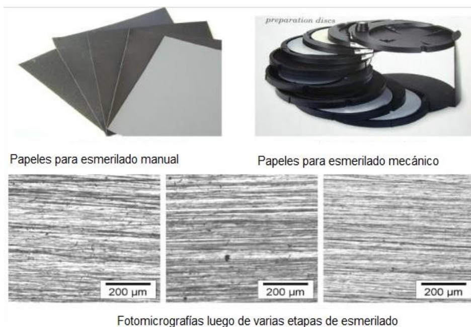
Figura 3.6. Papeles o lijas para esmerilado Fotomicrografía después de varias etapas de esmerilado
