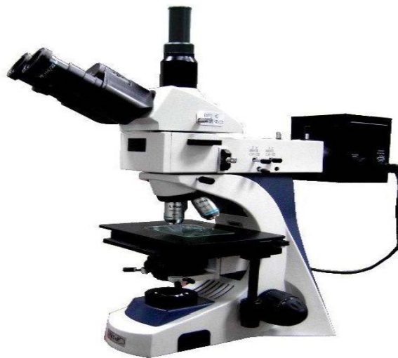
Figura 2.2 Microscopio metalúrgico y trayectoria de la luz a través del mismo.
