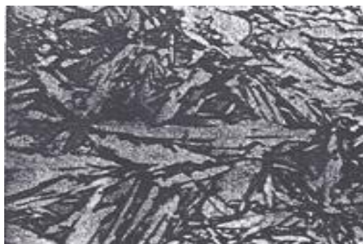
Agujas de martensita y austenita residual, acero 1.30%C, 200X
