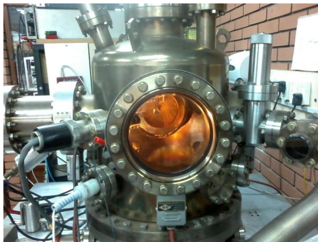
Figura 3.10: Cámara del espectrómetro Auger instalada en el Laboratorio Sputtering FC-UNI.
