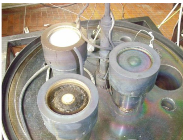
Figura 3.2: Configuración a detalle de los 3 cátodos y su disposición dentro de la cámara, en ellos se acoplan los targets. Cortesía Laboratorio Sputtering FC-UNI.
