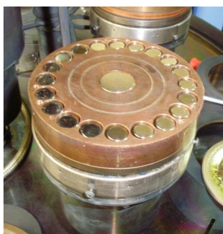
Figura 2.3: A la izquierda fotografía de la configuración de los imanes de neodimio debajo del target configuración magnética debajo del target. A la derecha (a) Vista de planta (b) Sección transversal de los magnéticos circulares. Cortesía del laboratorio Sputtering FC-UNI.
