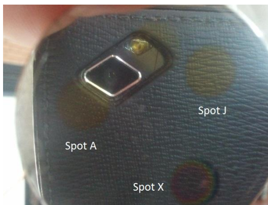
Figura 3.5: Substrato de acero en alto cromo SAE 5210, en la fotografía se puede apreciar todas las zonas o spots A, J y X depositadas.
