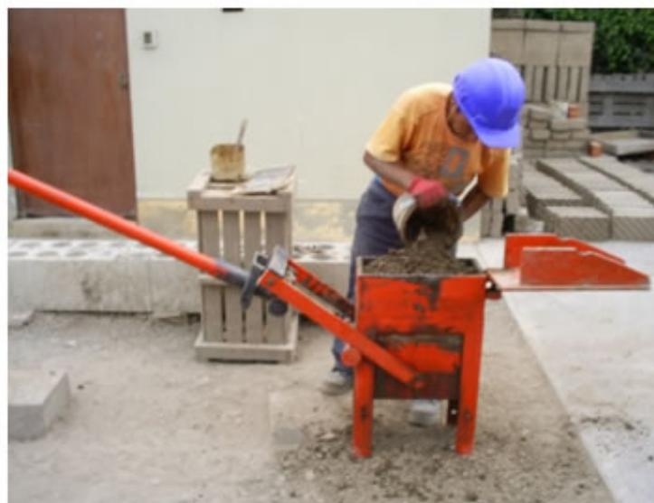
**Figura2.2**Proceso de Producción de ladrillo ecológico
