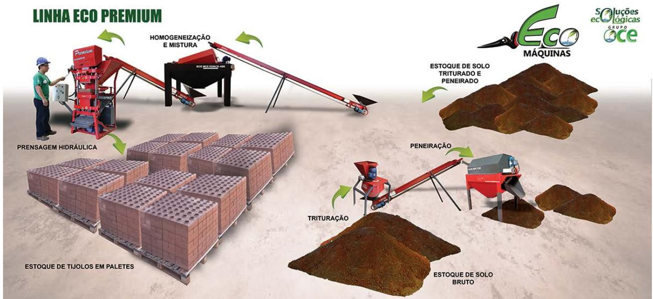
Figura 7.2 Vista en 3D modelo de fábrica
