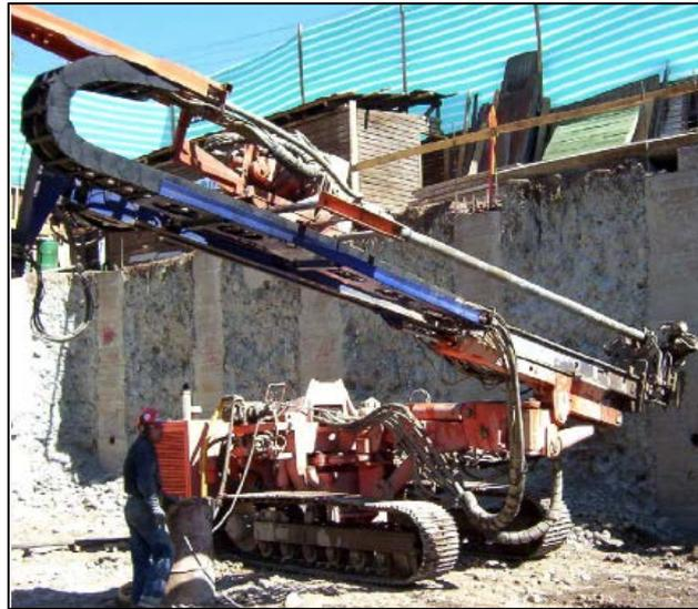
**Figura 3.8 Vista perforadora hidráulica sobre orugas**
