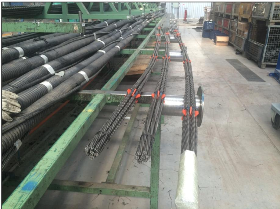
**Fig. 3.11 Vista de los componentes de un anclaje permanente- Cortesía Pilotes Terratest Perú S.A.C**
