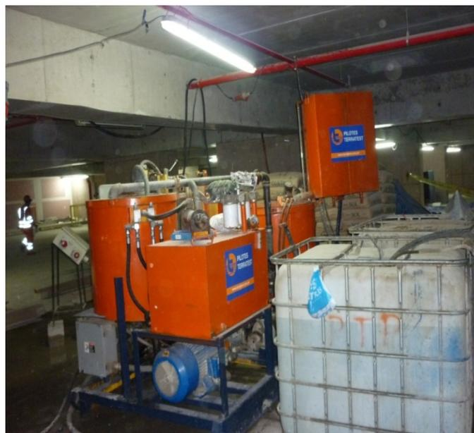
**Figura 2.12 Inyectora Chemgrout CG 600**
