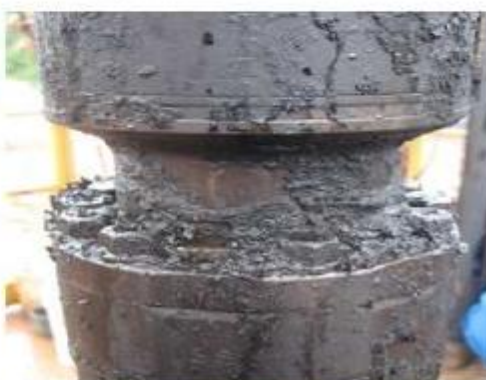
Bridas con presencia de asfaltenos
