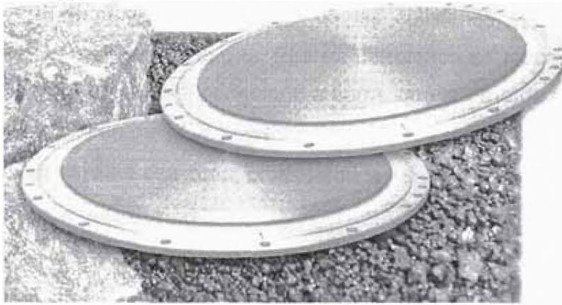
Fig. 2.7 Fotografía de targets para el RF. Magnetrón Sputtering utilizado en la elaboración de películas delgadas y filtros ópticos (Fabry-Perot), de la Facultad de Ciencias UNI [1].
