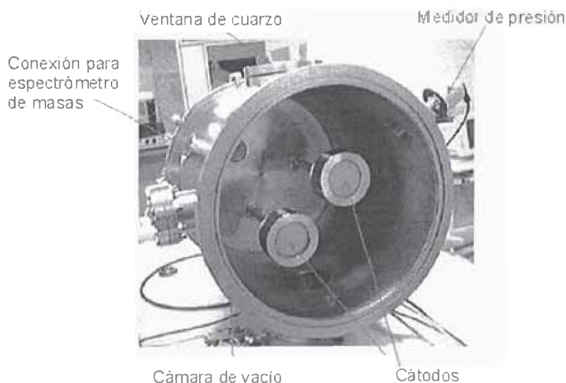
Fig. 2.8 Fotografía de un Magnetron Sputtering
