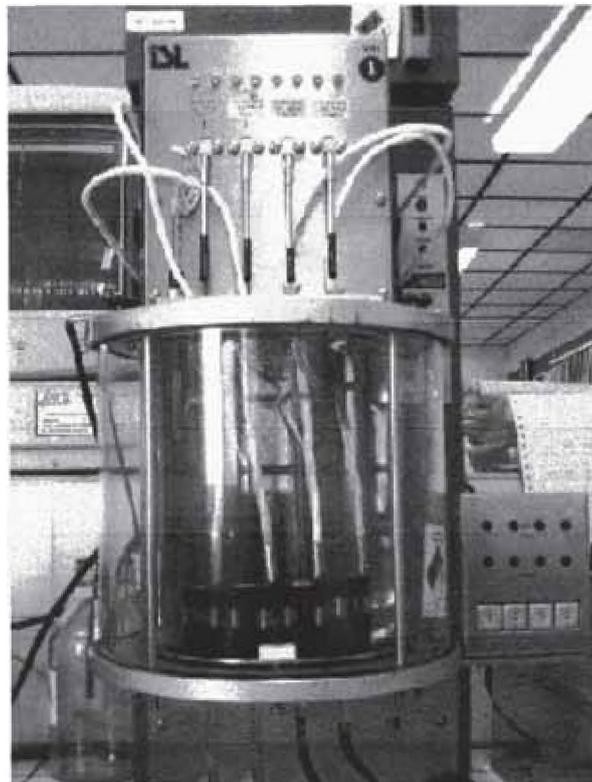
FIG 2.3 VISCOSIMETRO AUTOMATICO HOUILLON
