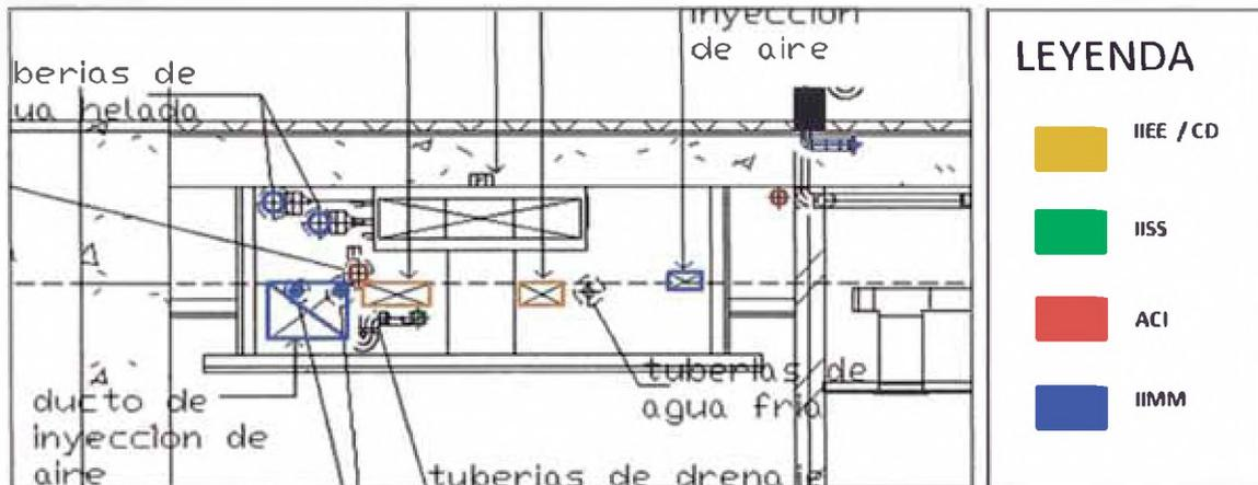
**Fig. 49 Corte de la solución a la interferencia 1. Fuente propia**
