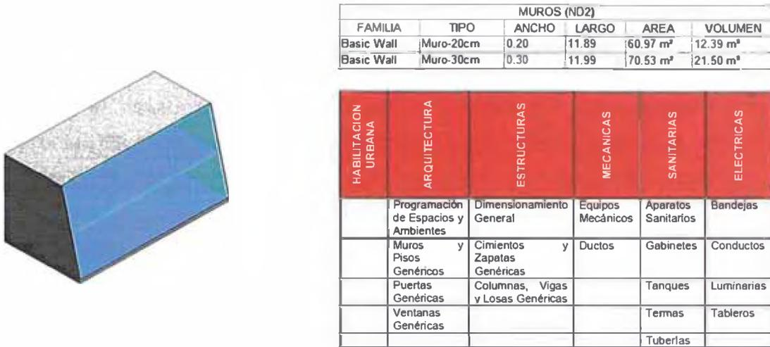
Fig. 11 Nivel de detalle 2 modelo BIM ( <http://www.comitebimdelperu.com> )
