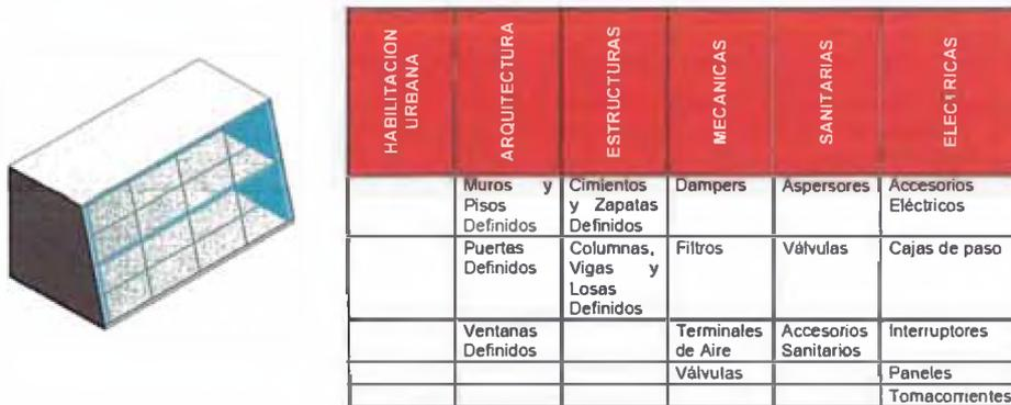
Fig. 12 Nivel de detalle 3 modelo BIM ( <http://www.comitebimdelperu.com> )
