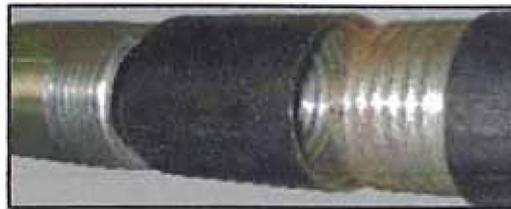
Figura N° 30. Unión con manguito macho - hembra
