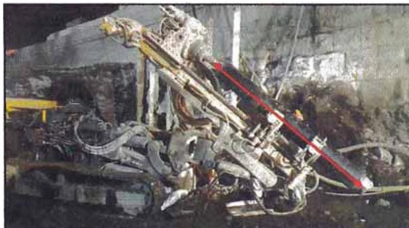
Figura N° 13. Sarta de perforación con tubería de revestimiento
