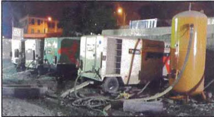
**Figura N° 20. Equipos de suministro de aire – Compresoras y pulmón de aire**
