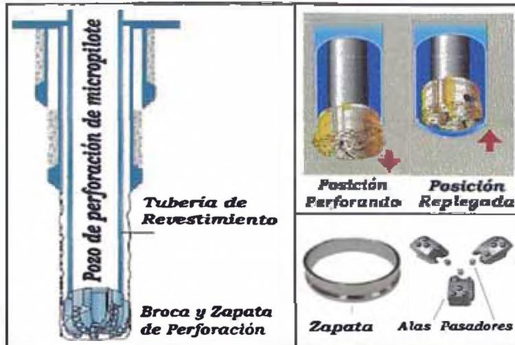
Figura N° 11. Esquema de sarta de perforación
