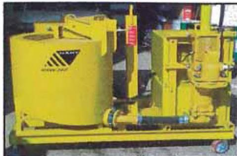
Figura Nº 17. Equipo de inyección de lechada de cemento
