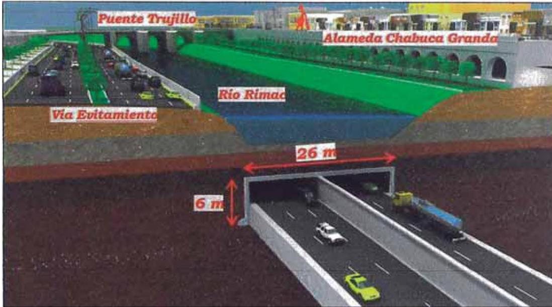
Figura N° 35. Esquema de túnel debajo del río Rímac – Proyecto Vía Parque Rímac
