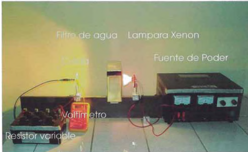
Fig. 19 Sistema experimental utilizado para la determinación de las curvas Corriente vs. Voltaje [32]
