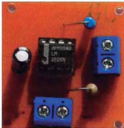
Figura 3.4. Circuito impreso del Integrado LM3909.
