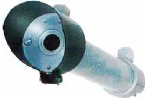
Figura 2.11. Pirheliómetro de primera clase Kipp-Zonen.
