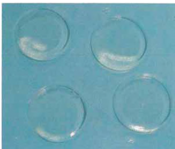
Figura 46. Monolitos de SiO 2 después del proceso de secado.
