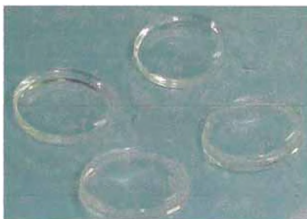
Figura 47. Monolitos de SiO 2 después del proceso de calcinación.
