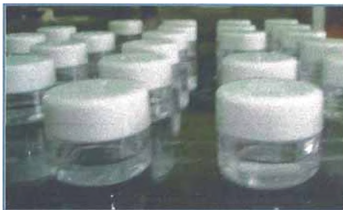
Figura 42. Muestras de \text{SiO}_2 en proceso de gelación.
