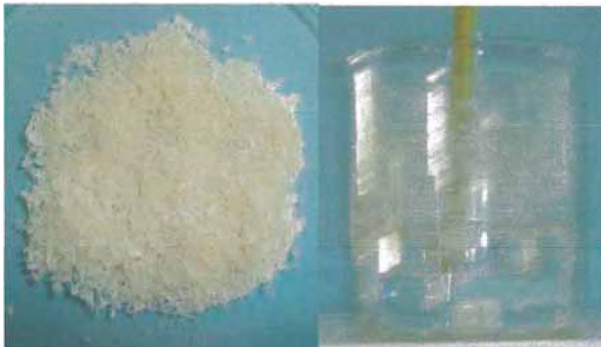
Figura 44. a) Quitosano en estado sólido b).- Solución de QT-HAC.
