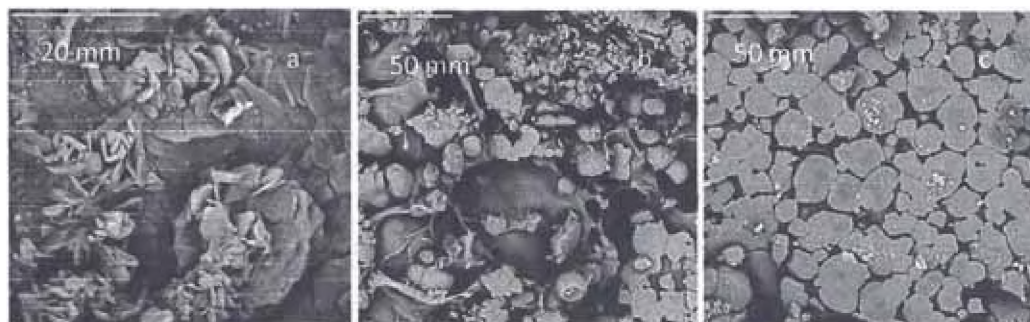
Figura 27: Micrografías SEM de \text{CaCO}_3 obtenidas usando como agente mineralizador mezcla Qui/Alg (1/2) para diferentes tiempos de cristalización: a) 6 horas; b) 8 horas y c) 24 horas.
