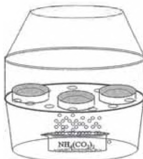
Figura 22: Esquema de la cámara de cristalización de carbonato de calcio usado para el Método de Cristalización II.
