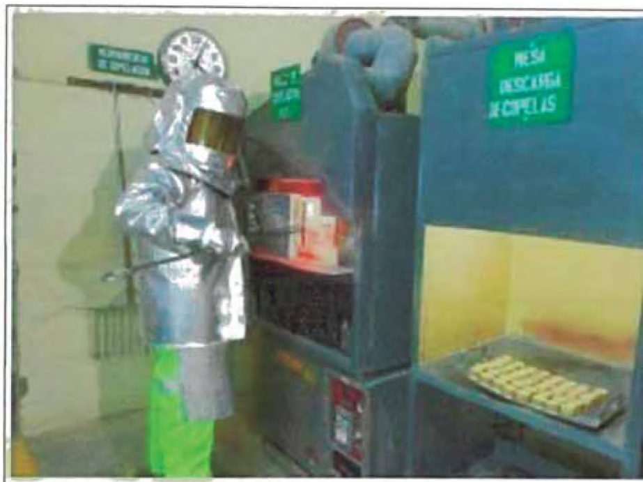
Fig. 7: Proceso de Copelación – Laboratorio Ares.
