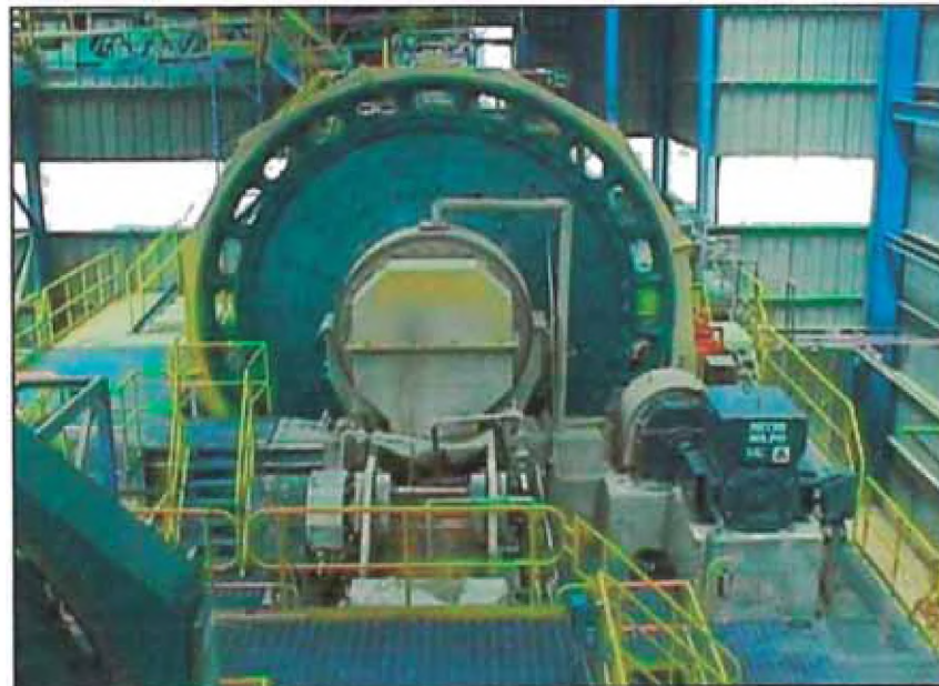
Fig. 5: Molino SAG - Planta de Beneficio U.O Ares.
