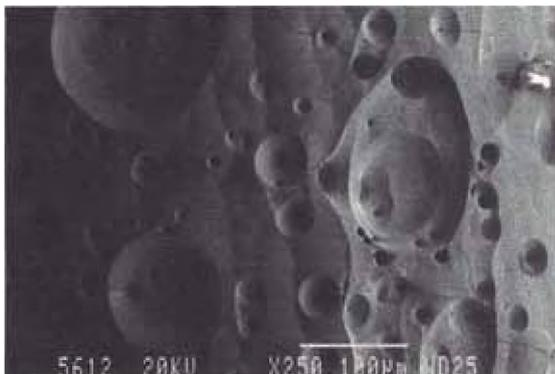
**Fig. 5.2.2c** Electrodo  $\text{PbO}_2\text{Bi}$  (0,433 %)/Pt/Ti imagen a 250 X, I= 5 mA
