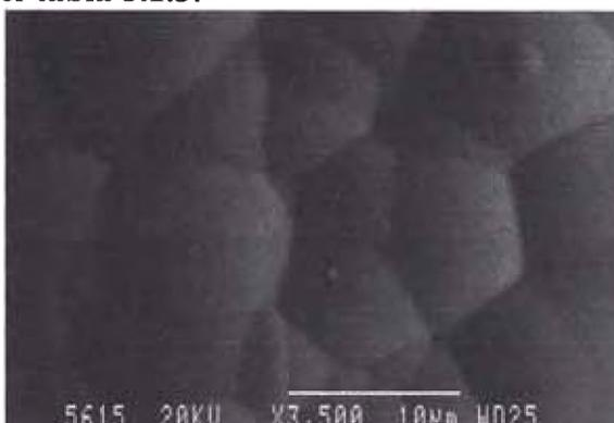
**Fig. 5.2.2f** Electrodo  $\text{PbO}_2\text{Bi}$  (0,433 %)/Pt/Ti imagen a 3500 X I= 2.5 mA
