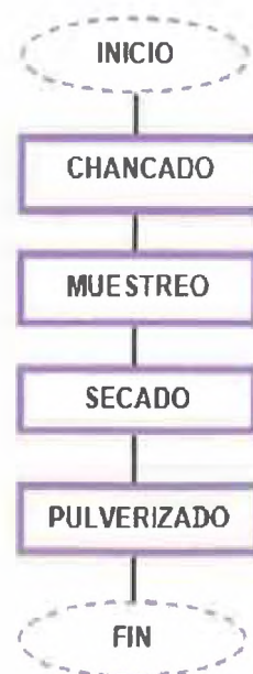
Figura N°10: Proceso de preparación mecánica.
