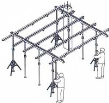
Figura N°15: Soporte de fondo de losa
