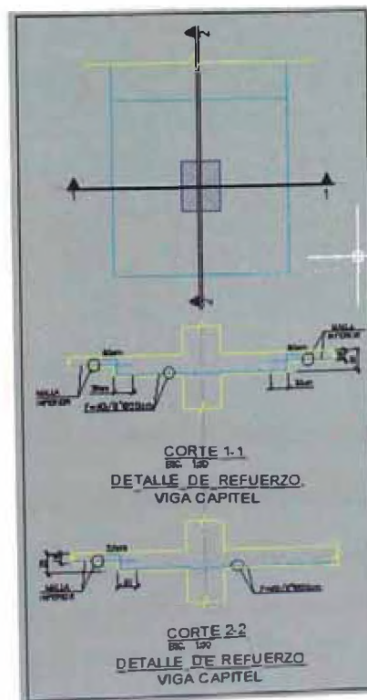
Figura N°22: Detalle de capitel
