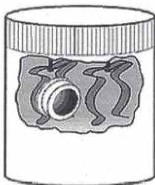
Fig12. Dispositivo de suspensión como protección contra las influencias atmosféricas
