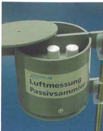
Fig 14. Dispositivo de protección contra la influencia atmosférica y de suspensión
