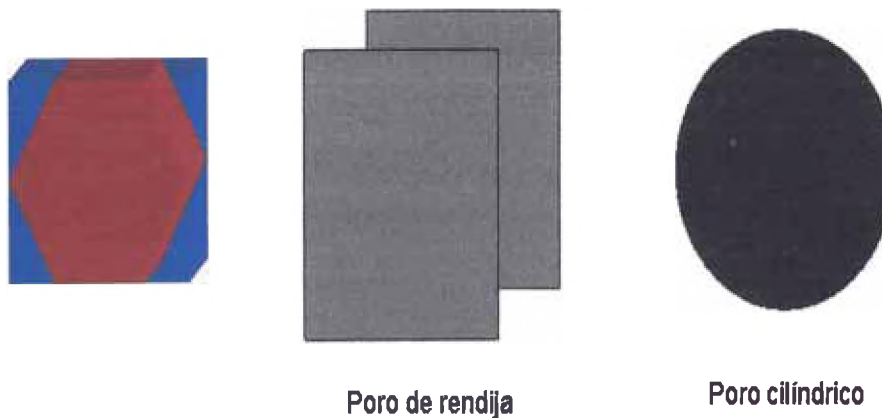
Fig 9. Ejemplo como de tamaño y la geometría del poro puede influir en la adsorción de distintos adsorbatos
