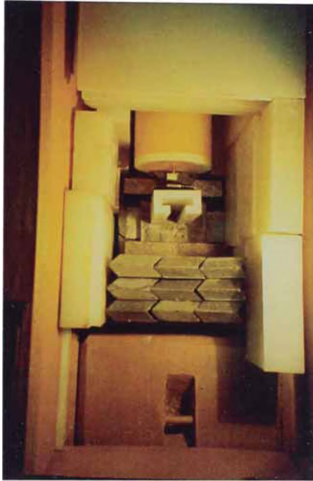
Figura N° A.5. Vista superior de la pieza final del colimador. Nótese una vez más las piezas de plomo, concreto y parafina para reducir las tasas de dosis gamma y neutrónica respectivamente.
