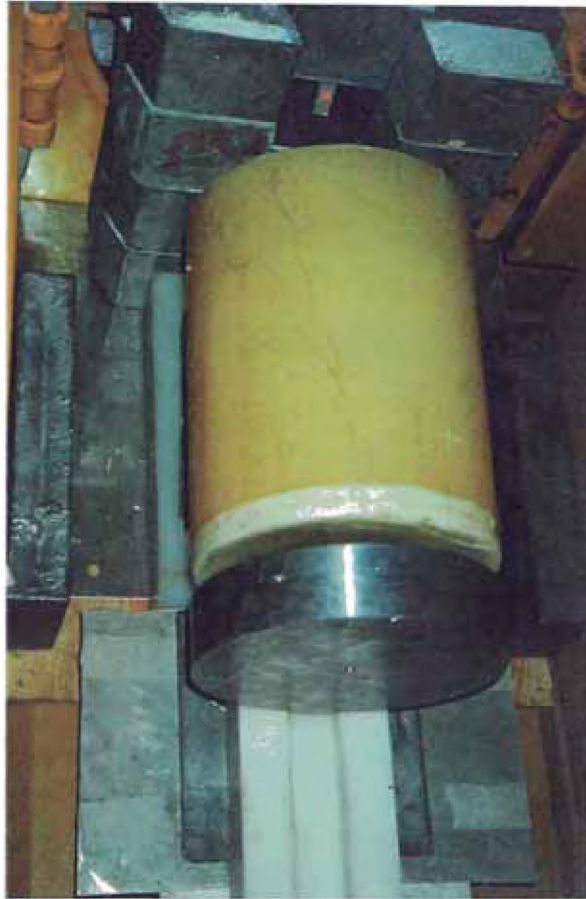
Figura N° A.3. Pieza final del colimador. Esta debe ser alineada con el colimador interno que se encuentra dentro del conducto de irradiación. Los bloques de plomo sirven para reducir la tasa de dosis gamma en los alrededores del recinto.
