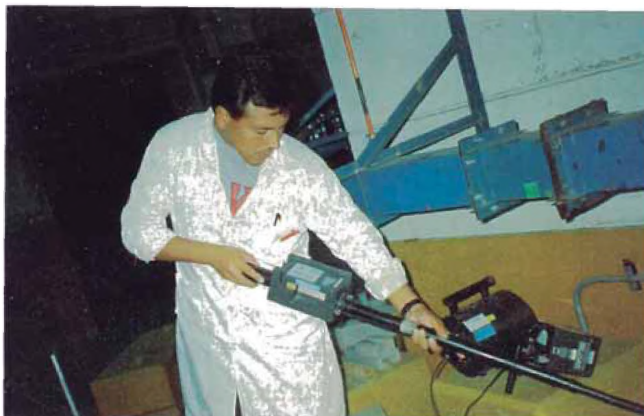
Figura N° A.8 Medición de las tasas de dosis gamma y neutrónica en el momento de la irradiación. Esta maniobra se realiza con frecuencia hasta que los blindajes usados permitan el registro de tasas de dosis que no den dosis por encima de los límites permitidos.
