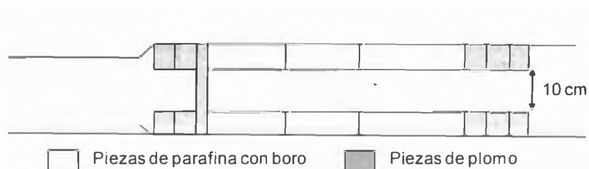
Figura N° 7. Configuración del colimador interno usado en la determinación del flujo neutrónico.
