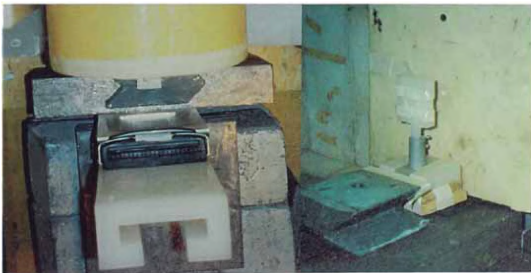
Figura N° A.6. A la izquierda se observa el posicionador del convertidor de disprosio. A la derecha se tiene el posicionador del cristal de NaCl.
