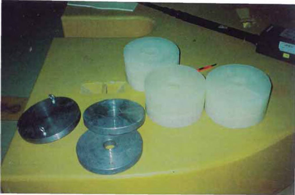
Figura N° A.1. Bloques cilíndricos de parafina y plomo. Se observan los discos de plomo con radio interno de 5 cm.
