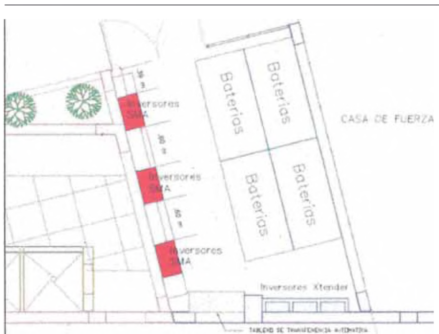
Figura 4-3. Vista de Planta de la distribución de equipos en la casa de fuerza.
