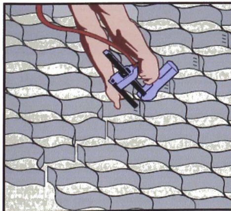
Figura N° G.14. Engrapado de las geoceldas. Fuente Andex.
