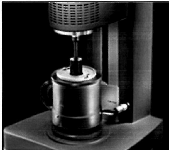
**Figura 2.3: Reómetro de cilindros concéntricos.**
