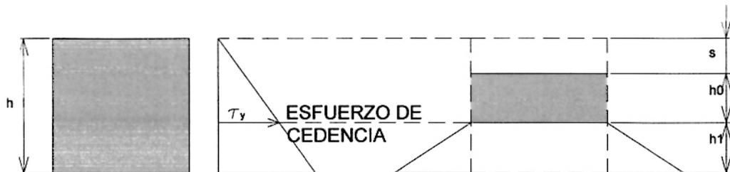
**Figura 2.6: Esfuerzo de cedencia en un cilindro colapsado.**
