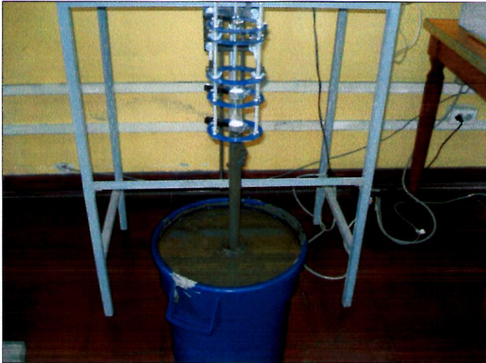
**Figura 3.10: Reómetro de caída de varilla. Muestra N°1 – Compañía Minera Cobriza.**
