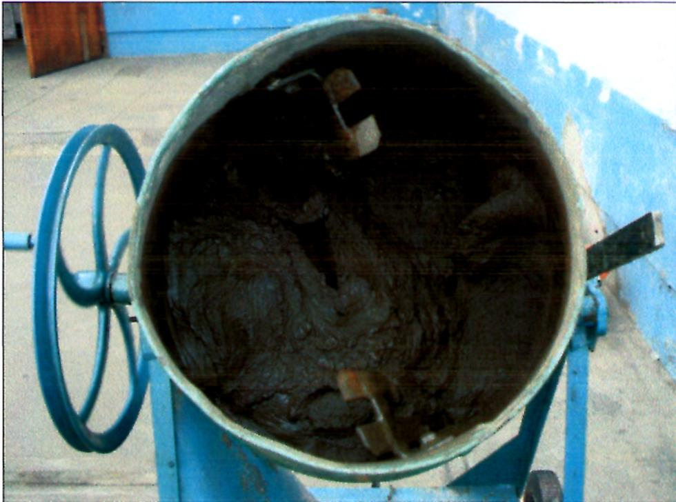
**Figura 3.9: Mezcla del relave con agua. Muestra N°1 – Compañía Minera
