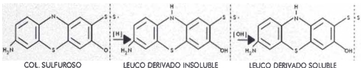
Figura 2.57. Proceso de reducción de los colorantes sulfurosos.
