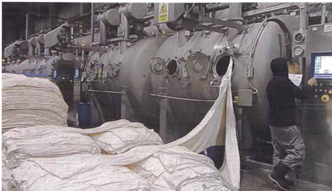
Figura 3.1. Ingreso de la tela cruda a la máquina de teñido.
