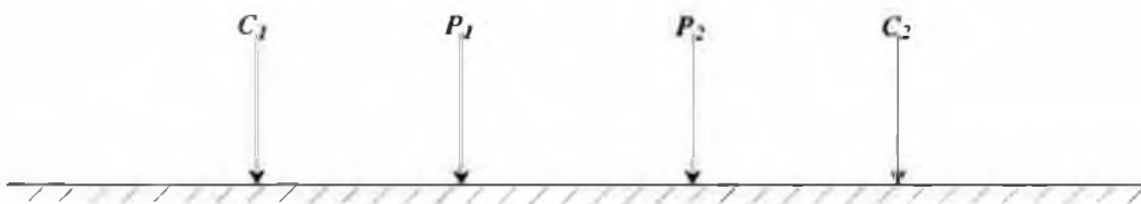
Figura 7 Configuración típica de 4 electrodos alineados
