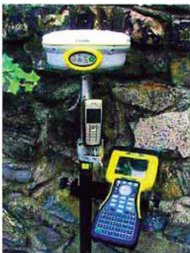
Figura 18 Equipo DGPS, Trimble 5700
