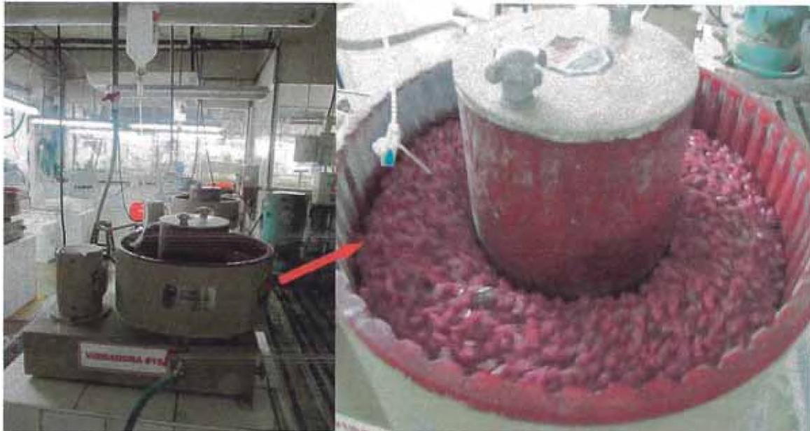
**Figura 2-4. Maquina de vibrado**
