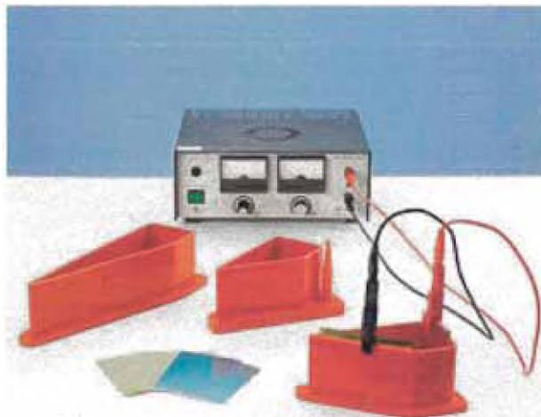
**Figura 3-5.**Análisis por Celdas de Hull
