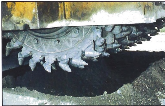
Figura N°13.- Rotor de recicladora
