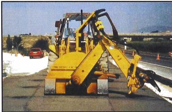
Figura N°20.- Máquina CRAFT (Equipo para la ejecución de Juntas)
