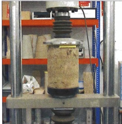
Figura N°04.- Ensayo de Resistencia a la compresión no confinada en probetas Tipo Marshall (UCS)
