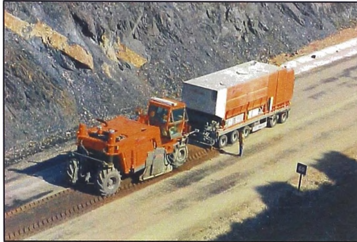
Figura N°14.- Recicladora con tolva de mezcla en suspensión.
