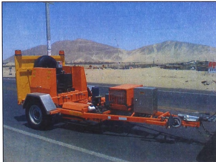
Figura N°10. – Deflectómetro de Impacto (FWD)
