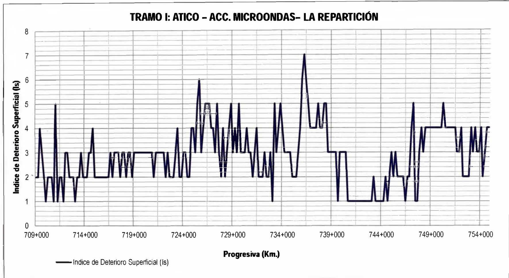
Figura N°28.- Medición del Índice de deterioro Superficial (Is) del Tramo I (Km. 709+000-754+020)
