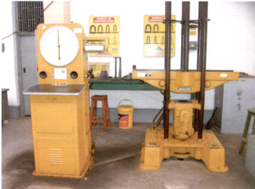
Fotografía N° 5.9.- Máquina universal para ensayos AMSLER
