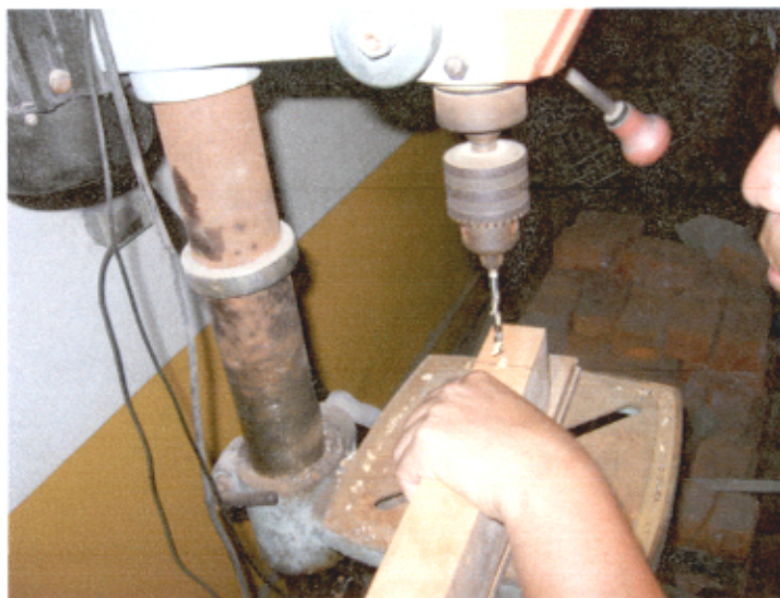
Fotografía N° 5.7.- Perforación de la pieza lateral
