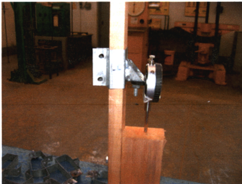
Fotografía N° 5.12.- Probeta de ensayo con abrazadera en la pieza lateral
