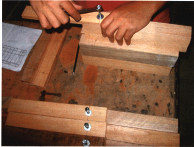
Fotografía N° 5.8.- Atornillado de las piezas
