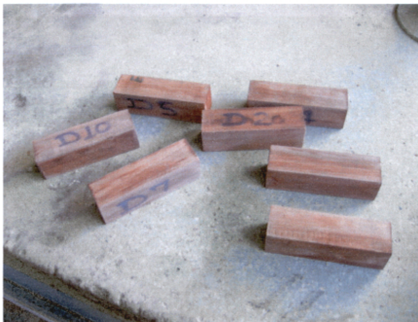
Fotografía N° 5.13.- Muestras para ensayo de densidad (3cm x 3cm x 10cm)
