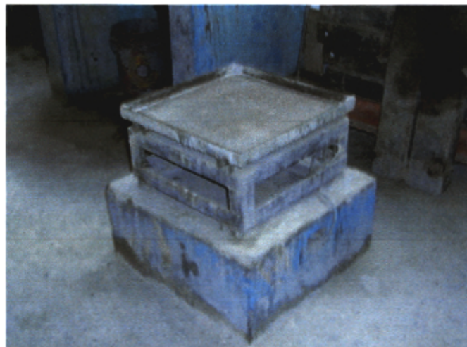
Figura 2.7 Mesa de sacudidas usada para la separación del agregado grueso.
