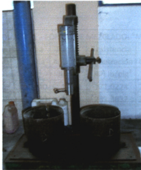
Figura 2.6 Aguja de Vicat usada para la determinación del Tiempo de fragua por medio de la resistencia a la penetración.
