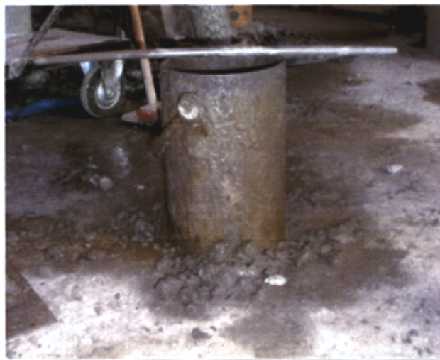
Figura 2.5 Ensayo del Peso Unitario Compactado del concreto.
