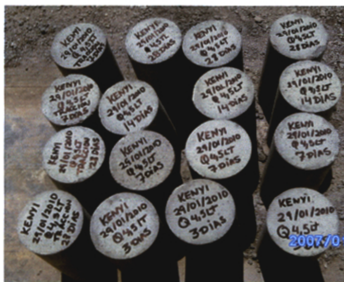
Figura 2.8 Testigos para pruebas del concreto endurecido.
