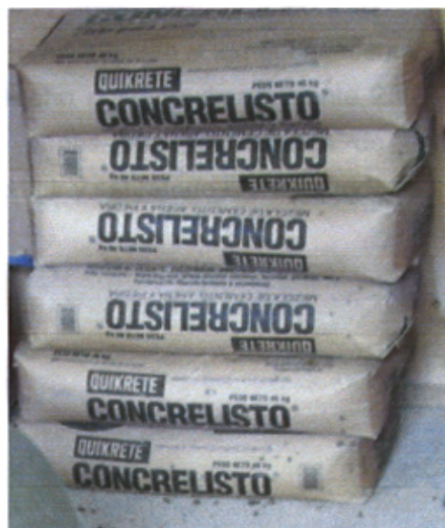
Figura 2.1 Concreto Quikrete almacenado a la intemperie.
