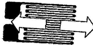
Además del principio de funcionamiento observado, también de da otro en las galgas, este se basa en la deformación de elementos semiconductores, la cual provoca una variación tanto en la longitud como en la sección, y de una forma más acusada, en la resistividad ( $\rho$ ) del semiconductor.
