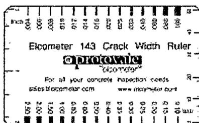
Este sencillo medidor se ha diseñado para determinar la anchura de una grieta en el cemento u otros materiales de construcción.
