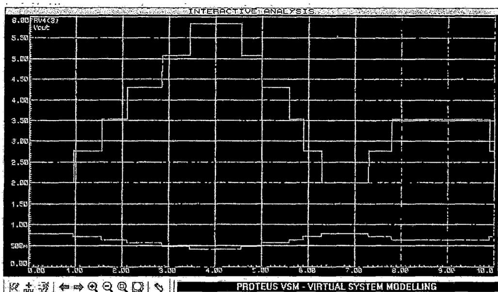
*Figura 3.57.- Simulación de señales del sensor de temperatura con el acondicionamiento de señal. La línea verde representa la señal del sensor de temperatura y la roja es la señal acondicionada*
