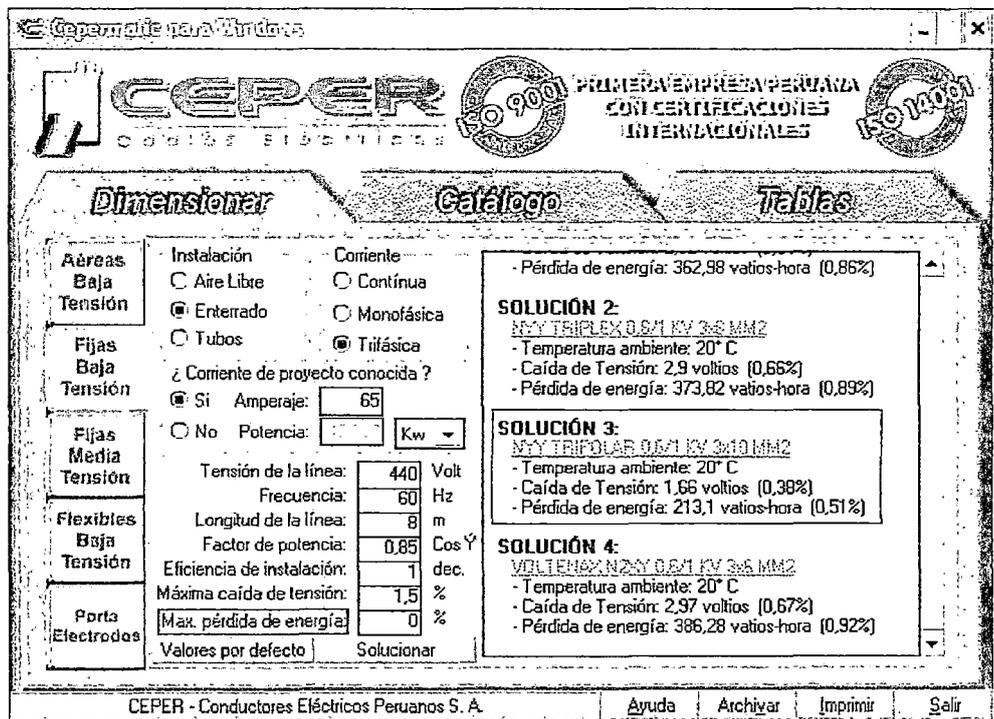
Figura 3.30 Selección del Cable alimentador TEQ-01 a TD-01
