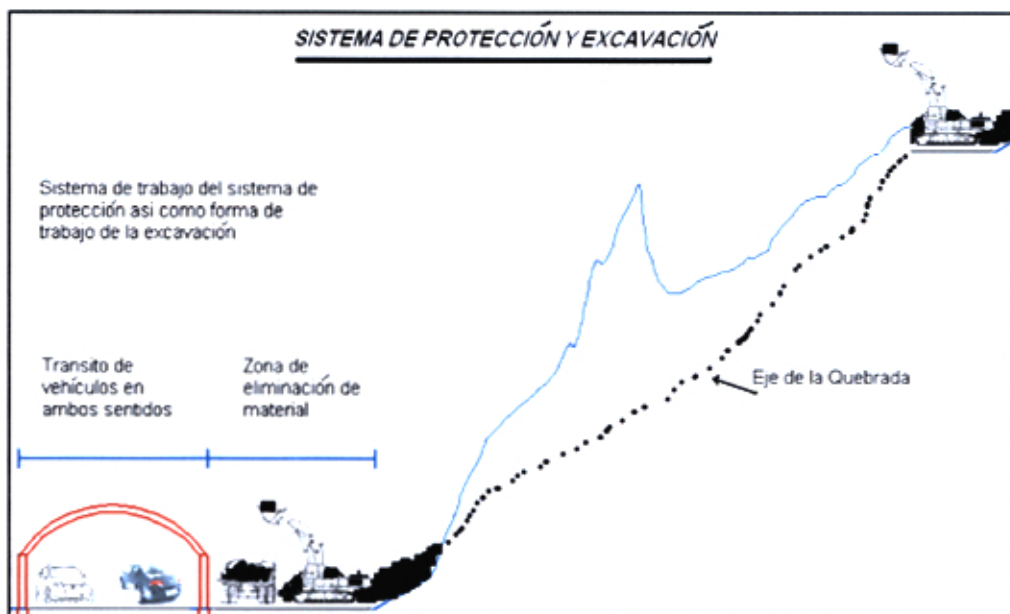
Figura 4.16 Sistema de protección utilizando valla semiesférica (túnel)
