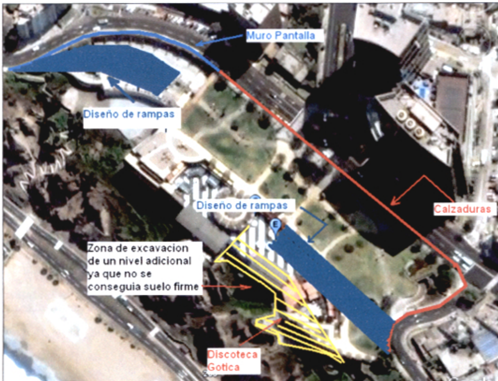
Figura 2.4 Esquema de excavación del centro turístico Larcomar.
