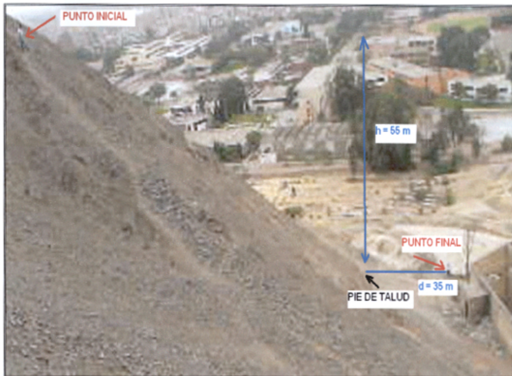
Fotografía 6.1 Esquema del experimento de caída de rocas realizado en la UNI
