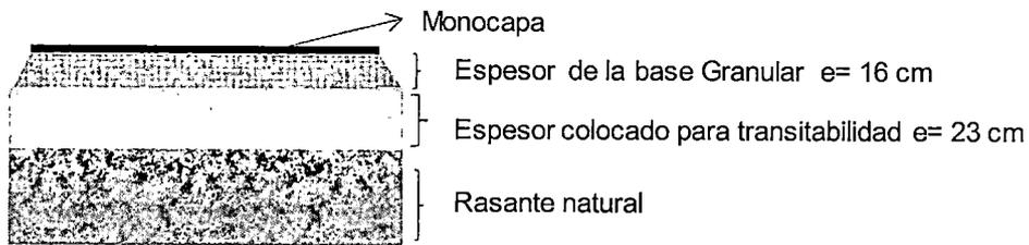
Figura N° 6.9 Estructura del Pavimento (Fuente: Elab.propia)
