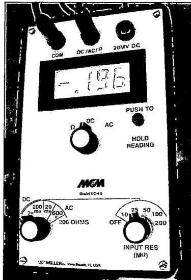
Figura 6.10. Voltímetro de Alta impedancia
