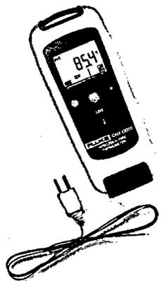
**Figura 4.8: Termocupla tipo K y termómetro electrónico FLUKE.**
