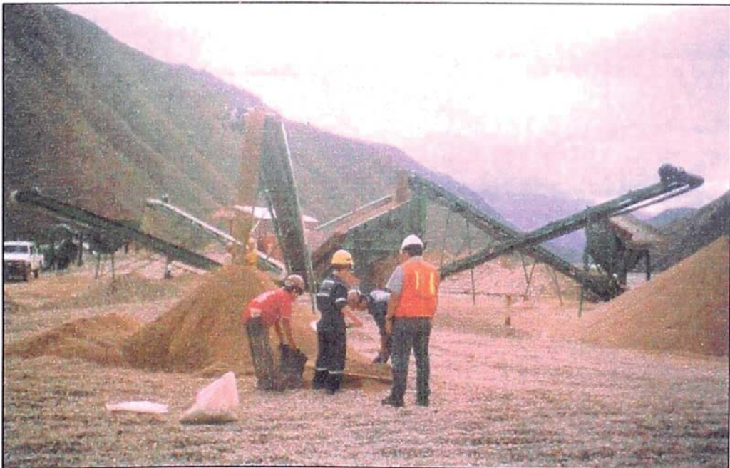
FOTO 32. Otra Vista del material de filtro procesado en la zaranda eléctrica de Piaz.
