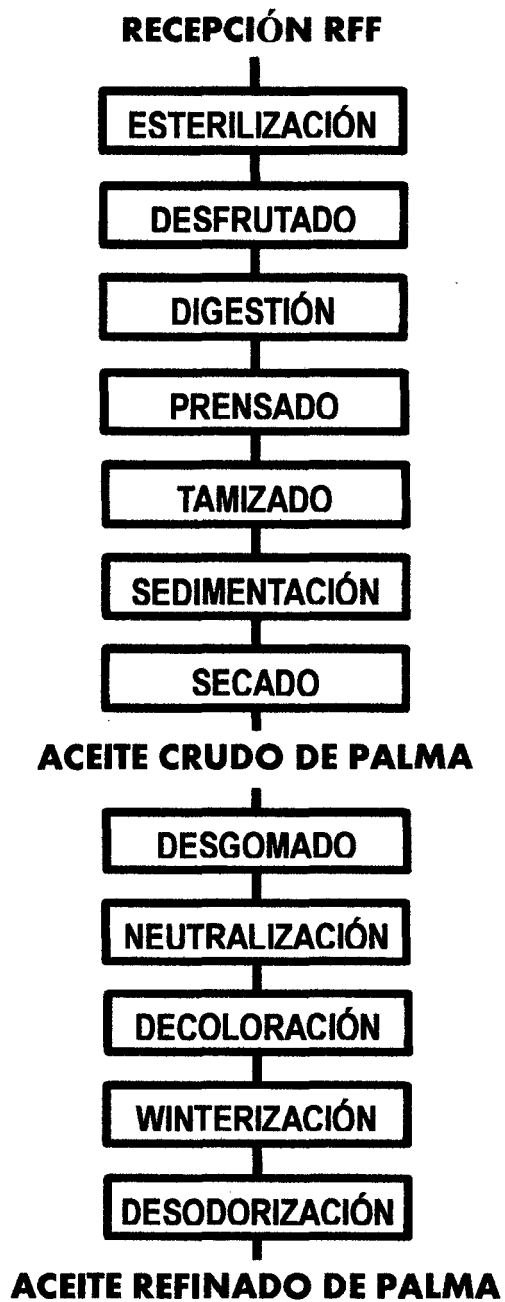
Figura N° 24: Diagrama de Flujo del procesamiento de la palma aceitera.
