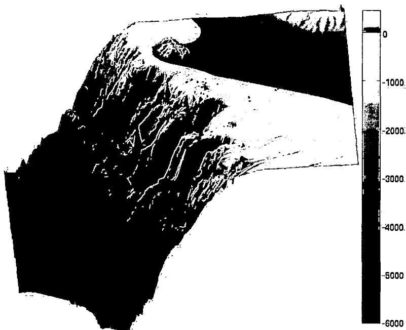
Figura 5.1: Predicción de la batimetría a alta resolución (100 metros, exageración vertical x 20).
