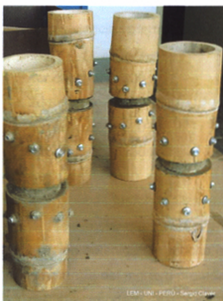
Fotografía N°.4.37 y N°.4.38: Probetas vaciadas utilizando mortero prefabricado y posterior resultado. Interior de probeta luego de sometida a tracción.
