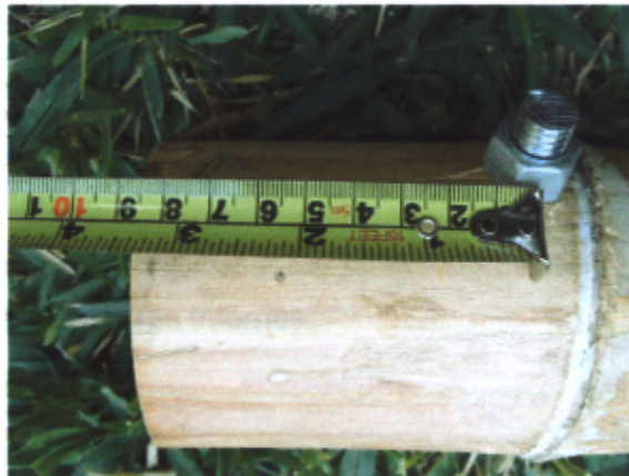
Fotografía N°.4.21 y N°.4.22: Colocación del tornillo al interior de la probeta de bambú y posición del perno de 1/2" dentro de la probeta.
