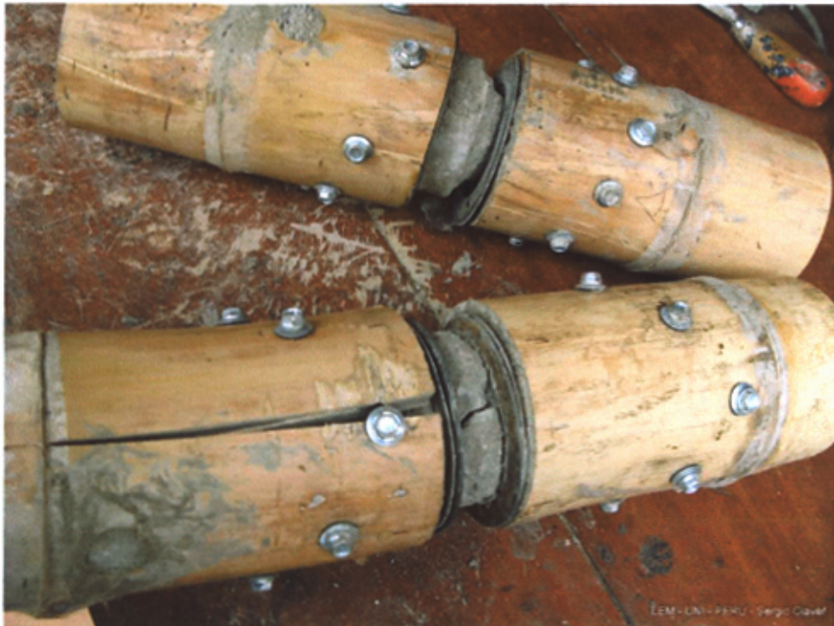
Fotografía N°.4.40: Probetas con mortero con relación a/c de 1/3 luego del ensayo.
