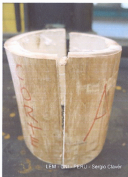
Fotografía N°.3.8: Fallas longitudinales al realizar la prueba.
