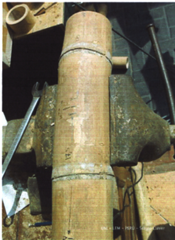
Fotografía N°.4.30: Demarcación de dimensiones para realizar el corte.
