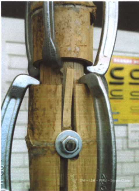
Fotografía N°.4.23 y N°.4.24: Prueba de tracción, probetas con madera tornillo al interior y la falla y desplazamiento observados.
