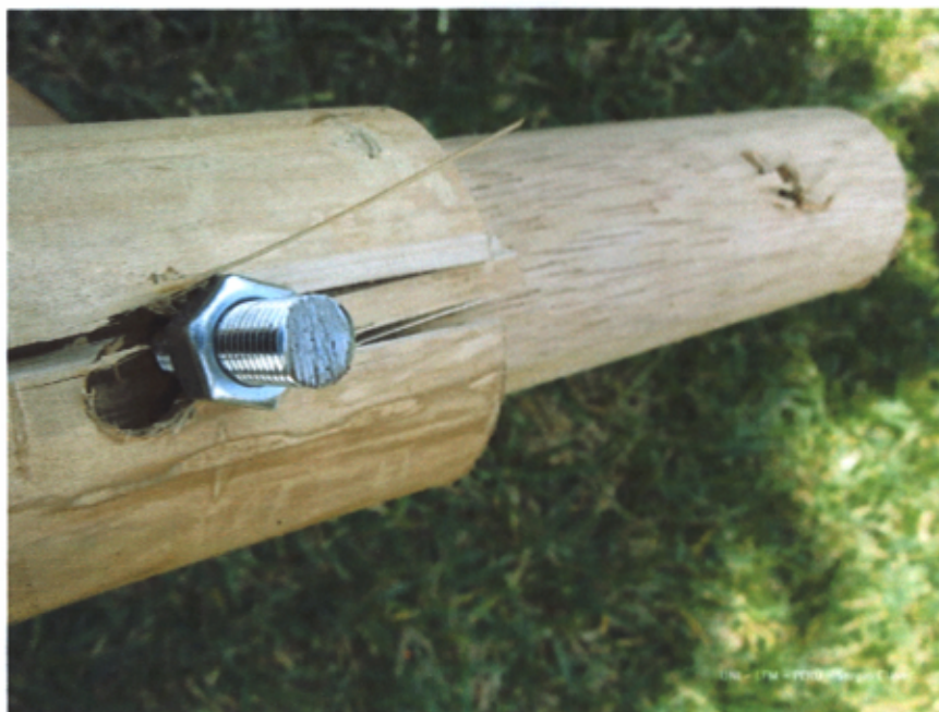
Fotografía N°.4.25: Efecto en el tornillo y en el bambú luego de la prueba.
