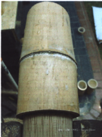
Fotografía N°.4.21 y N°.4.22: Colocación del tornillo al interior de la probeta de bambú y posición del perno de 1/2" dentro de la probeta.
