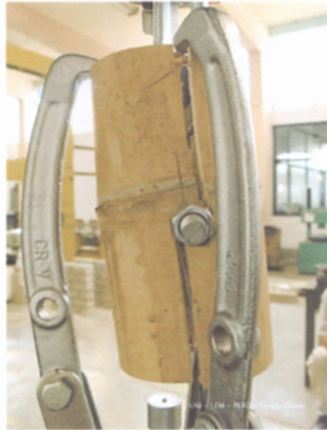
Fotografía N°.4.10 y N°.4.11: Falla completa del bambú al ser sometido a carga.
