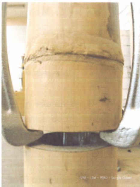
Fotografía N°4.5 y N°4.6: Uso de 1 templador y 1 perno de 1/2 en cada lado de la unión.
