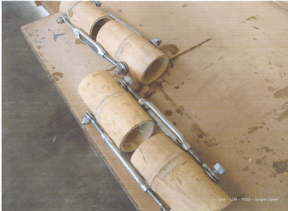
Fotografía N°.4.17: Prueba a tracción con templadores colocados exteriormente.
