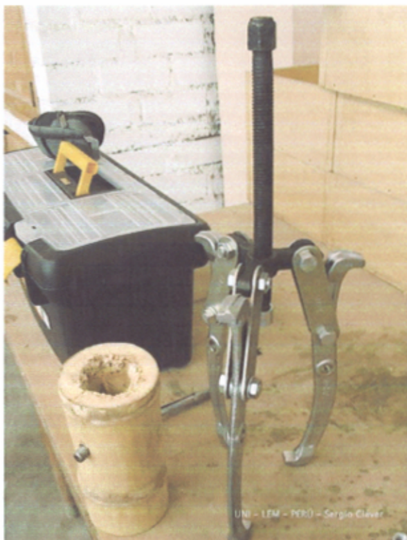
Fotografía N°.4.1: Elemento utilizado para someter a tracción al bambú – Los extractores de 8”.
