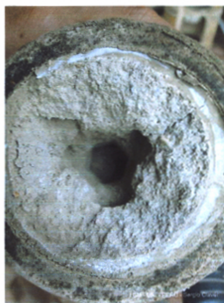
Fotografía N°.4.37 y N°.4.38: Probetas vaciadas utilizando mortero prefabricado y posterior resultado. Interior de probeta luego de sometida a tracción.
