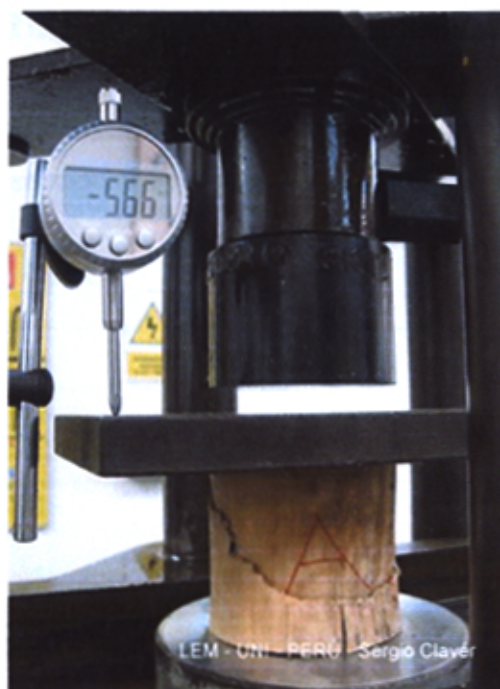
Fotografía N°3.1: Probeta luego de sometida al ensayo de compresión y deformímetro digital con una precisión de 0.01 mm.
