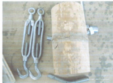
Fotografía N°.4.14 y N°.4.15: Deformación de pernos y sin deformación notable en los templadores.
