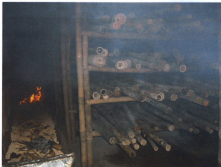
Fotografía N° 1.11: Curado al Humo
