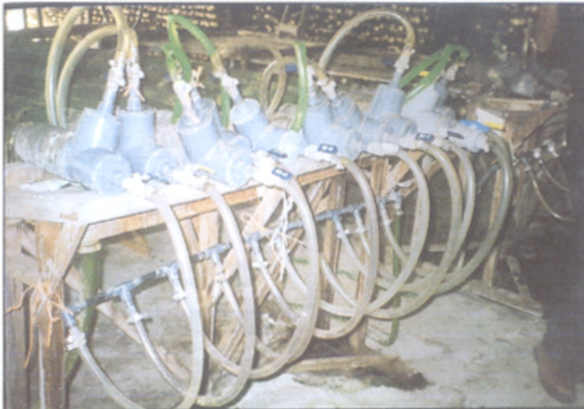
Fotografía N° 1.13: Aplicación del método Boucherie.
