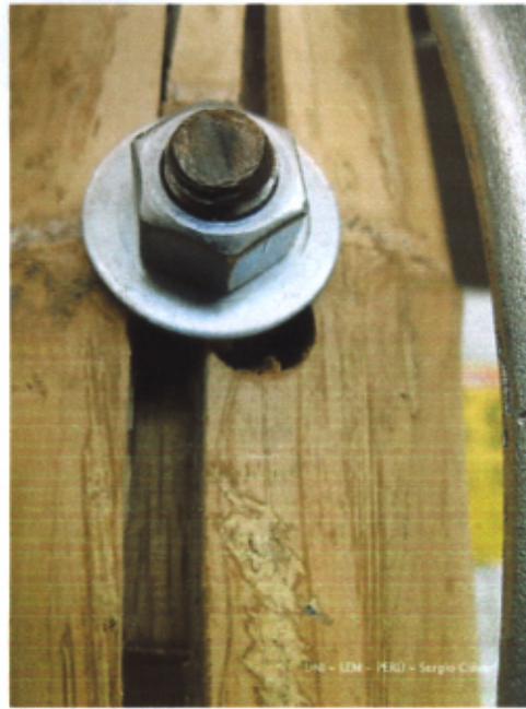
Fotografía N°.4.23 y N°.4.24: Prueba de tracción, probetas con madera tornillo al interior y la falla y desplazamiento observados.
