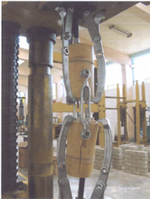
Fotografía N°.4.18 y N°.4.19: Prueba de tracción con templadores exteriores y desplazamiento debido a la tracción.
