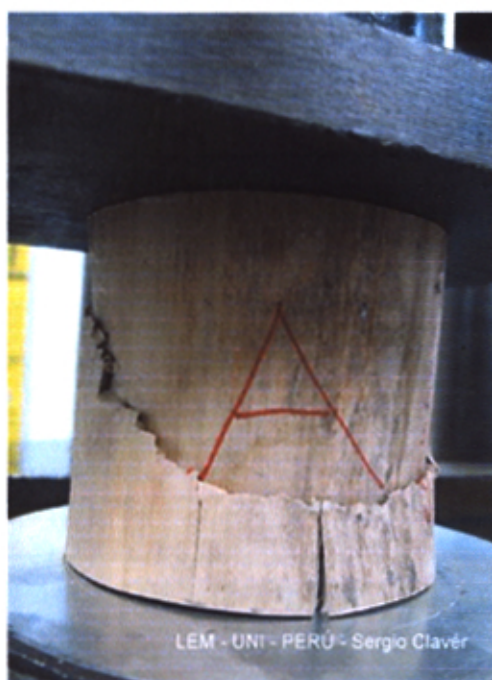
Fotografía N°3.2: Aplastamiento de la sección transversal.
