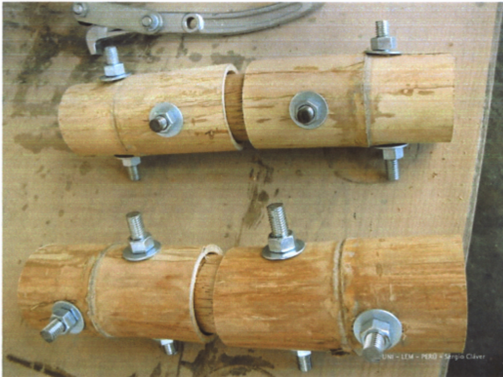
Fotografía N°.4.26: Uso de tornillo interior con dos pernos de ½" en cada extremo.
