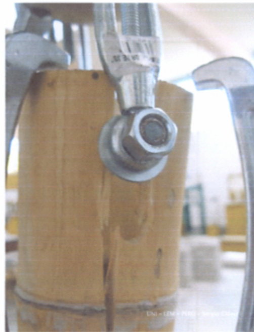
Fotografía N°.4.18 y N°.4.19: Prueba de tracción con templadores exteriores y desplazamiento debido a la tracción.
