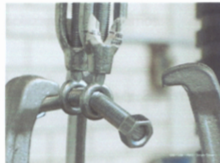
Fotografía N°.4.12 y N°.4.13: Deformación apreciada en perno transversal de \frac{1}{2} " de aproximadamente 1 cm.
