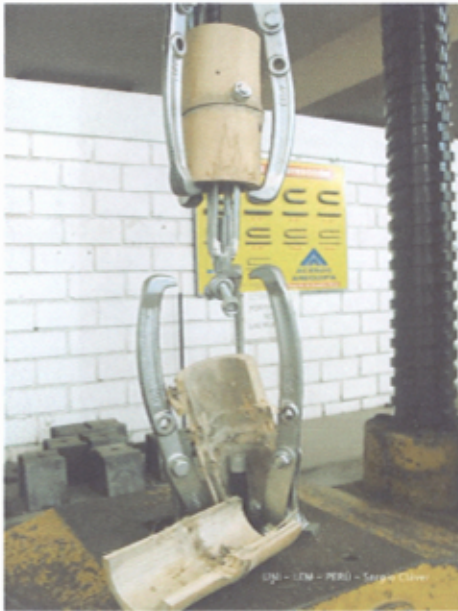
Fotografía N°.4.10 y N°.4.11: Falla completa del bambú al ser sometido a carga.
