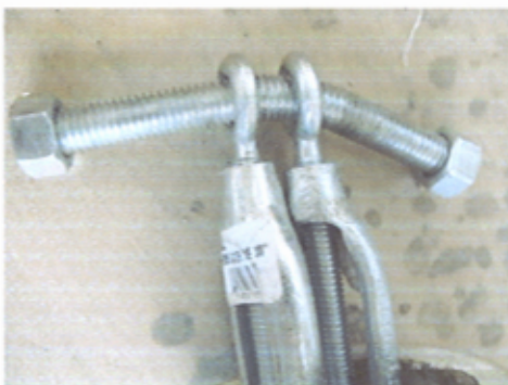
Fotografía N°.4.14 y N°.4.15: Deformación de pernos y sin deformación notable en los templadores.
