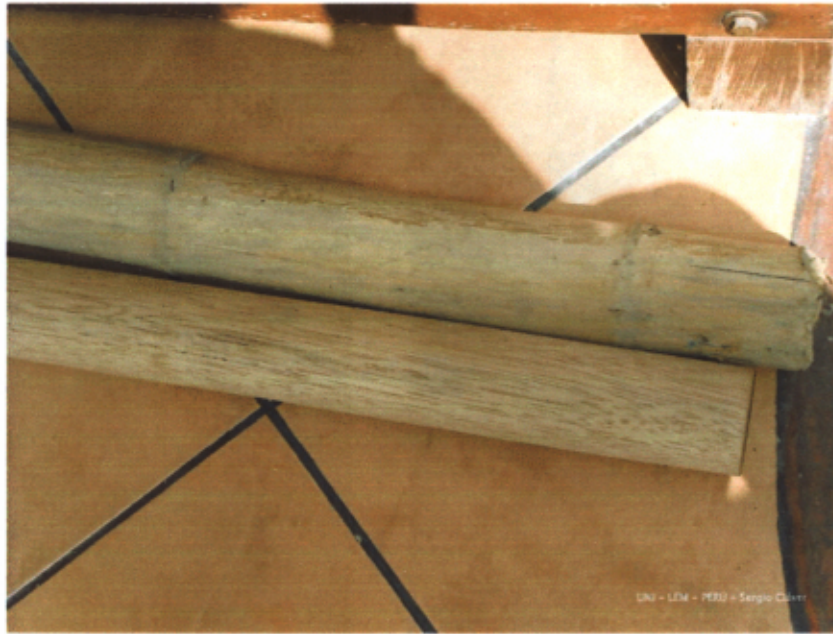
Fotografía N°.4.20: Tornillo de sección circular, luego de proceso de torneado y lijado.
